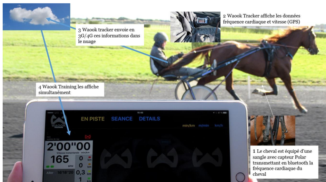
Figure 1 : Principe de fonctionnement de Waoook Tracker
